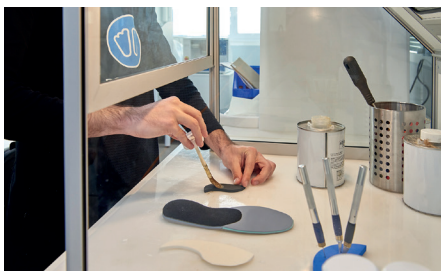
Encolado de los elementos de contención.
