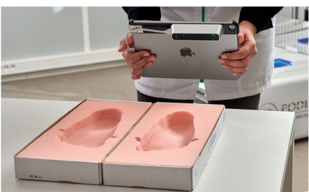
Escaneo de huellas en espumas fenólicas.
