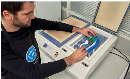
Termomoldeado de la OPCT® sobre el molde.
